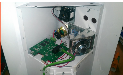
Cara interior del esquinero multiservicio de celda. Tarjeta interfono IPFON
