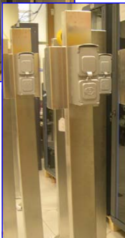
Aspecto de los mástiles de telefonía de vía con el conector de vía, el Terminal y la baliza de alta sonoridad.
