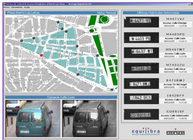
Interfaz del aplicativo Monitor de control de puntos de acceso en tiempo real.
